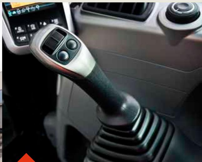
Manipulateurs avec molette commandée au pouce intégrée pour une commande ultra-précise de la flèche et des circuits hydrauliques auxiliaires double effet.
