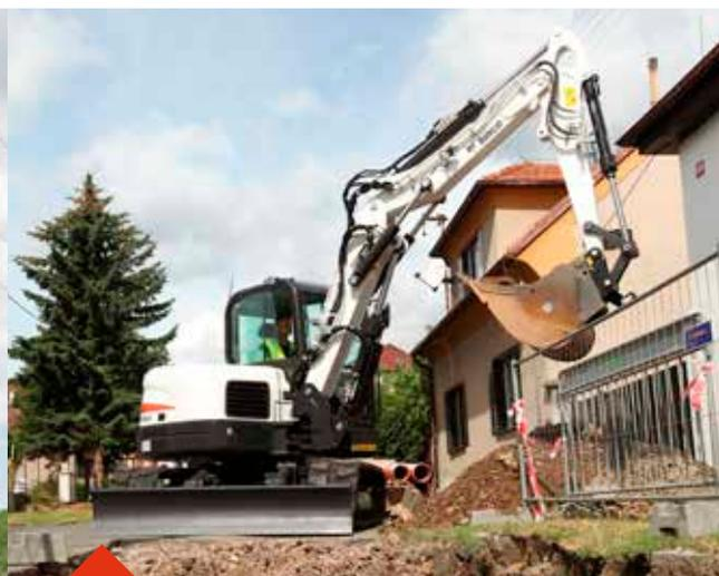
La flèche articulée en option vous permet d'utiliser votre pelle sur des chantiers très divers. Sa hauteur de déversement, sa longue portée et son exceptionnelle capacité de rétraction – ainsi que son rayon d'orientation minimal – multiplient les possibilités offertes sur les divers types de chantier.
