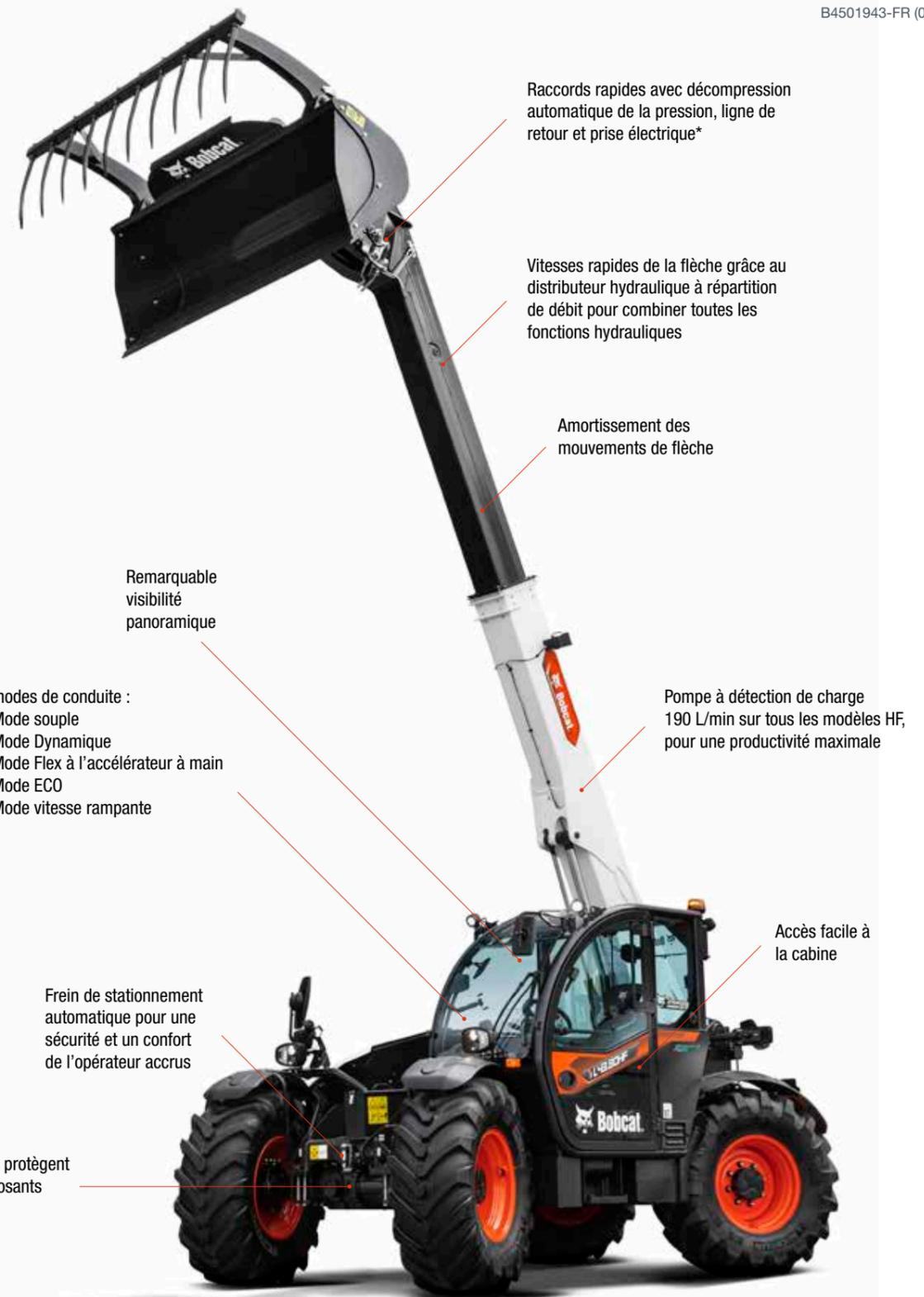
Raccords rapides avec décompression automatique de la pression, ligne de retour et prise électrique\*
