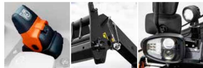
Accélérateur manuel et entraînement Flex | Verrouillage hydraulique des accessoires via une conduite auxiliaire dédiée | Pack d'éclairage routier LED :
