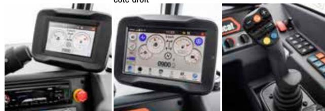
Écran 5" standard avec radio Bluetooth, microphone et haut-parleurs | Écran tactile 7" (radio Bluetooth avec micro et gestionnaire de tâches) | Manipulateur Smart
