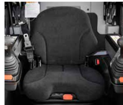
Siège suspendu confortable proposé de série et siège chauffé en tissu à suspension pneumatique disponible en option, pour un maximum de confort tout au long de la journée, et de l'année.
