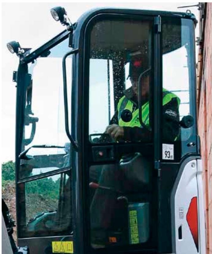
Cabine TOPS/ROPS avec chauffage
