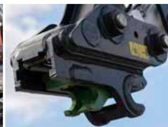
Attache hydraulique à verrouillage sur axes
