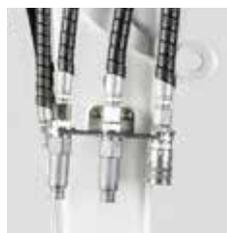
Circuit hydraulique auxiliaire (AUX1) sur le balancier
