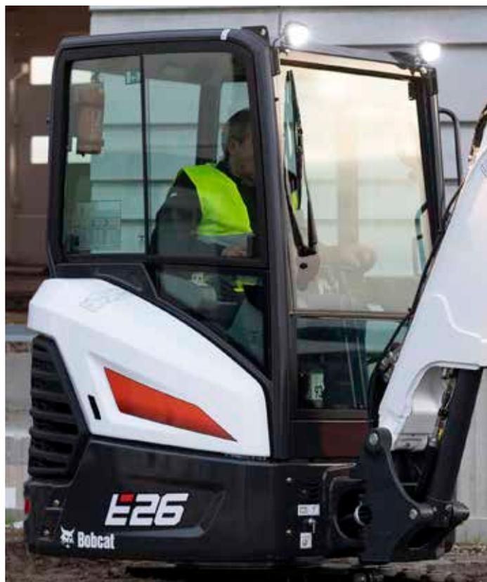
Cabine TOPS / ROPS / FOPS avec chauffage
