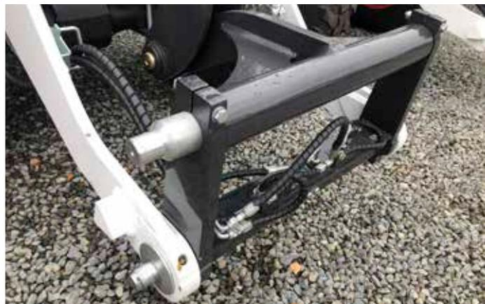
Raccord Quick-Tach (installé de série)
