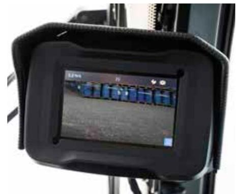
Commandé par le sélecteur, l'écran LCD affiche les informations vitales de la machine et bascule automatiquement sur la diffusion de la caméra de recul quand vous passez en marche arrière.
