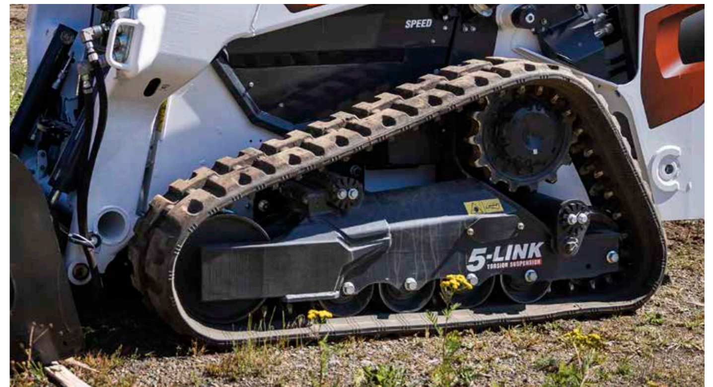
Suspension sur barres de torsion à 5 articulations
