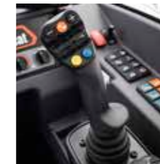
Manipulateur Smart avec position flottante de la flèche et secousses du godet
