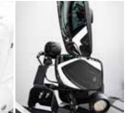
Feux de travail LED supplémentaires et rétroviseur électrique avec dégivrage
