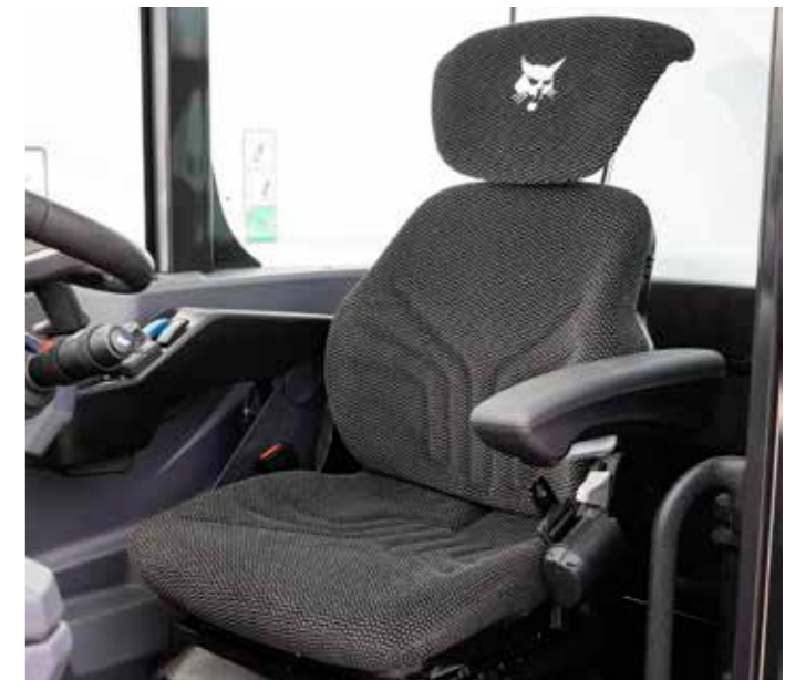
Siège à suspension pneumatique Grammer Maximo avec chauffage, Dynamic Dumping System (DDS) et manipulateur monté sur l'accoudoir suspendu
