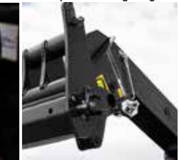
Verrouillage hydraulique des accessoires par une ligne auxiliaire spéciale
