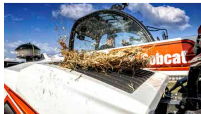
Inversion automatique du ventilateur
